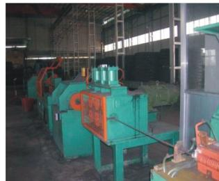
钢棒线材经双臂旋转结构的放线架放线、理线架理线，使盘条环形变成直线型，防止乱线后进入拉拔刻痕机，拉拔机的卷筒直径和拉拔力都很大，拉拔范围即进线的最大直径和出线的最小直径一般会大于2:1，为保证产品外观质量PC钢棒凹螺纹成型采用拉拔速度与模具旋转速度匹配的方式，因此拉拔主电机和旋转模电机需要采用变频器的控制，拉拔电机不仅功率大而且要求具有高的转矩控制特性。
